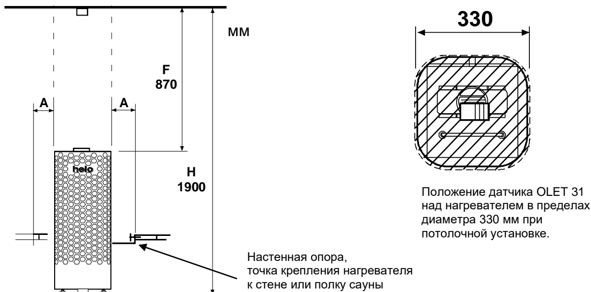
Рис 2 Безопасные расстояния электрокаменки
