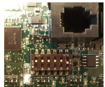
Bild 4 DIP-brytarplaceringar för användning av en elaggregat
